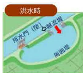
大雨が降って、石狩川の水位が上がると越流堤を越えて川の水が遊水地に入ります。
