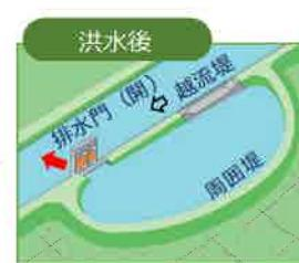
石狩川の水位が下がり始めると排水門を開けて、遊水地に貯めた水を石狩川に流します。
