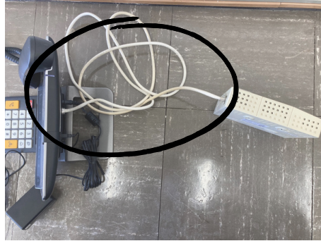
②IP告知端末機とONU（白い箱状の機器）はケーブルで接続されています
